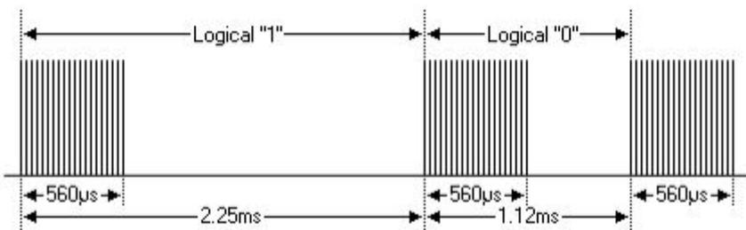
El protocolo establece que primero se emite 9ms de una señal alta, y luego 4.5ms de señal baja para empezar el envío de una señal de 8 bits, empezando por el bit más bajo LSB hasta el más alto MSB y luego su complemento. Todo en una señal de 38kHz donde se modula primero la dirección y luego el comando. Mejor con un dibujo ¿no?
