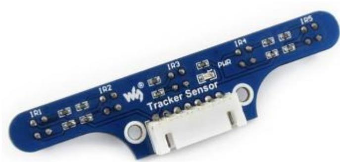
Tiene un funcionamiento similar al Sensor obstáculos IR. El receptor tiene un sensor de reflexión de infrarrojos ITR20001/T. Un led emite luz IR continuamente, la luz infrarroja es reflejada por un obstáculo y lo recibe el receptor.
