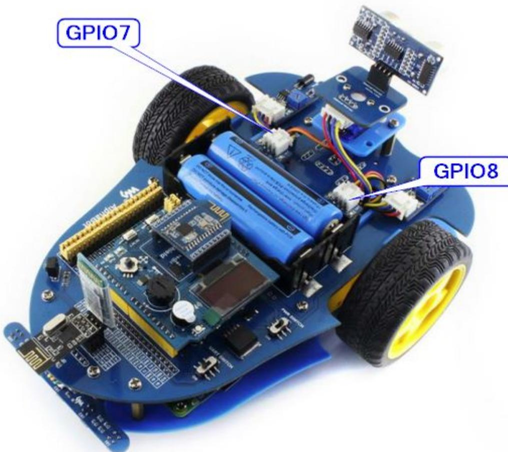
Si te fijas en el esquema anterior, las resistencias, están con la configuración **PULL-UP** ([aquí para saber +](#) en el curso Arduino) ¿qué significa esto? pues que van al revés, cuando el circuito está encendido, o sea detecta agujero, estado ON transmite un 0 lógico, y al revés, cuando está apagado OFF transmite un 1 lógico, lo puedes ver mejor en estas fotografías:
