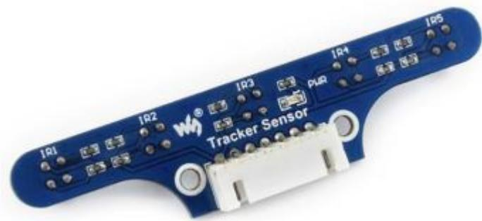
Tiene un funcionamiento similar al [Sensor obstáculos IR](#). El receptor tiene un sensor de reflexión de infrarrojos ITR20001/T. Un led emite luz IR continuamente, la luz infraroja es reflejado por un obstáculo y lo recibe el receptor.
