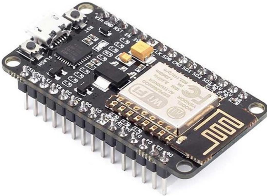
Es una placa de desarrollo basado en el **SoC** ([System on a chip](#)). ESP8266 e incorpora la comunicación Wifi que tanto falta en el Arduino.
