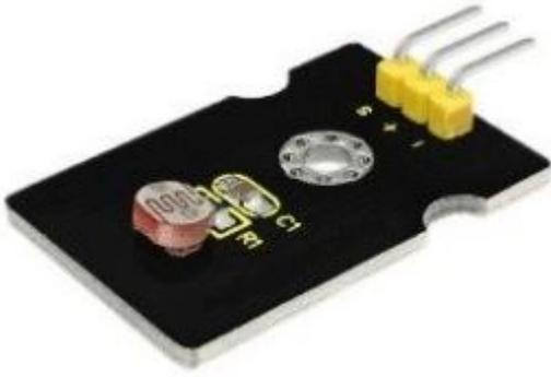
El LDR es una resistencia que varia con la luz. La conexión interna de este sensor analógico hace que **cuanto más luz menos valor nos proporciona** por lo tanto va al revés. Esto será importante para la configuración de nuestros programas, por ejemplo el medidor "Gauge" de la APP Blink de este vídeo va de 1023 a 0 para medir correctamente la cantidad de luz:
