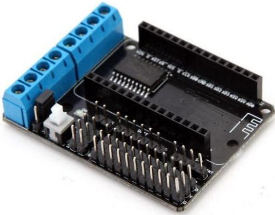
Esta shield permite conectar motores en los 4 primeros terminales azules con el NodeMCU que se coloca en el zócalo. Para saber cómo funcionan los motores con esta shield [ver aquí](#)
