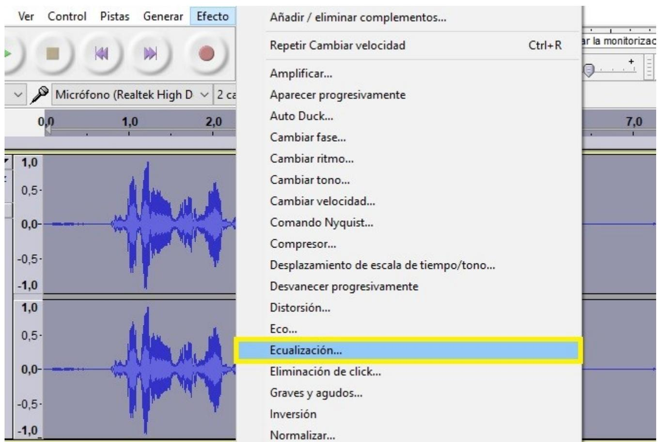
**El Ecualizador** es un cuadro con dos ejes. El eje horizontal es la barra de frecuencias desde 20 Hz, hasta 20.000 Hz, cubriendo toda la gama de espectro audible por el ser humano. En el eje vertical es el eje de los decibelios (o volumen) de cada frecuencia, donde podemos resaltar o borrar frecuencias a nuestro gusto.
